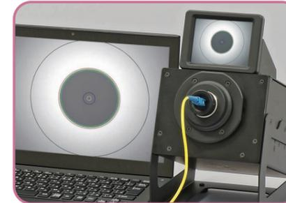
光コネクタ端面検査装置は、光コネクタを機器に差し込むだけで端面の詳細な検査が可能です。また、自動判定プログラムにより、どなたにでも簡単に合否判定ができます。
