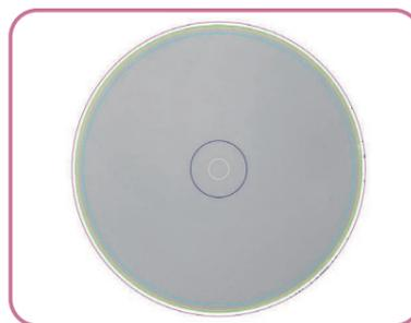
軽量・コンパクトで携帯性に優れ、チップ交換だけでさまざまなコネクタの観察に対応しており、現場での光コネクタ端面確認作業に最適です。また、光コネクタ端面状態の合否判定も自動でおこないます。
