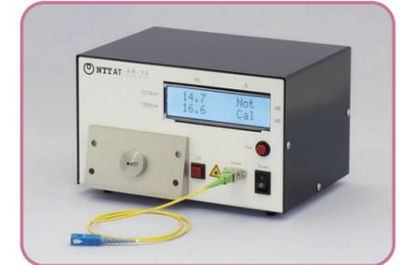
光コネクタ特性測定器AR-10は、2波長(1310nm/1550nm)の特性をすばやく測定できます。製造現場に合わせて手押しスイッチ、または付属のフットスイッチが選択可能です。
